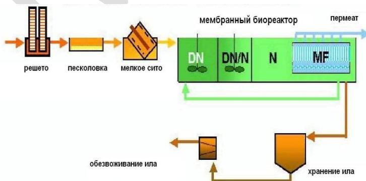
**Рисунок 50. – Схема очистки вод в г. Каарс [50]**
