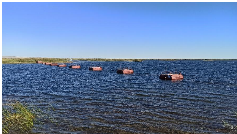
Рис. 3. Плавающие опоры около Кокаральской плотины для крепления подводных динамиков, 30.08.20 г.
